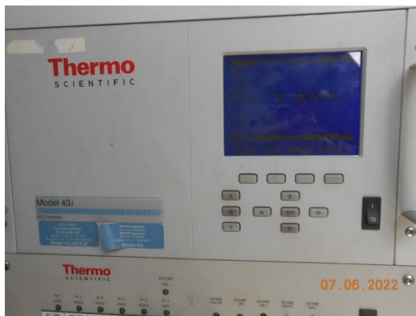
รูปที่ 3 ระบบตรวจวัดคุณภาพอากาศที่ระบายจากปล่องระบายอย่างต่อเนื่อง (CEMs)
